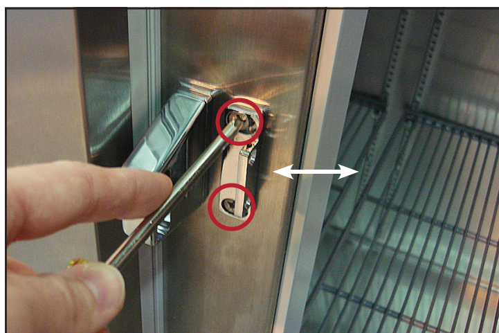
Рис. 6. Местонахождение винтов крепления основания замка. Отрегулировать положение основания замка по горизонтали.
