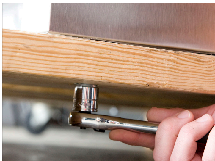
Fig. 3: Remova os parafusos do estrado.
