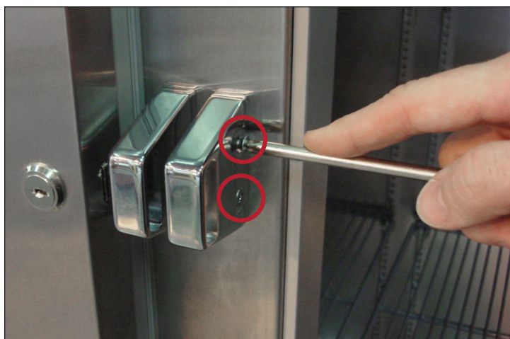
Fig. 5: Localização dos parafusos do fecho de travamento.
