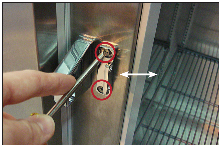
Fig. 6: Localização dos parafusos da base do fecho. Ajuste a base do fecho lateralmente.
