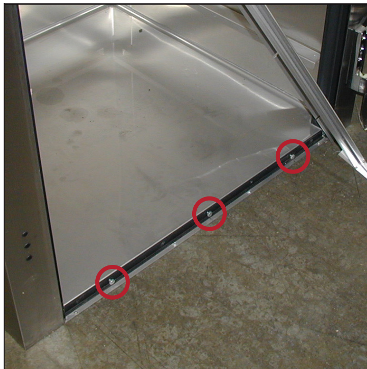
Fig. 1: Localização dos parafusos de aperto manual.
