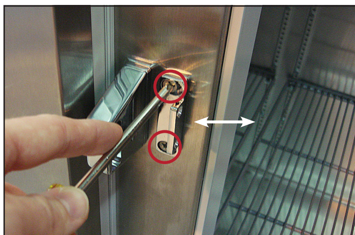
Rys. 6. Położenie wkrętów podstawy zamka. Wyregulować podstawę zamka w kierunku bocznym
