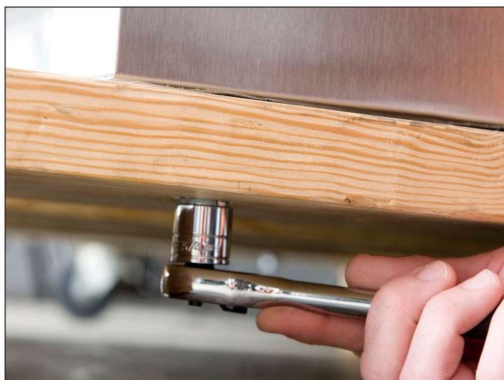
Rys. 3. Wykręcić śruby ramy palety.
