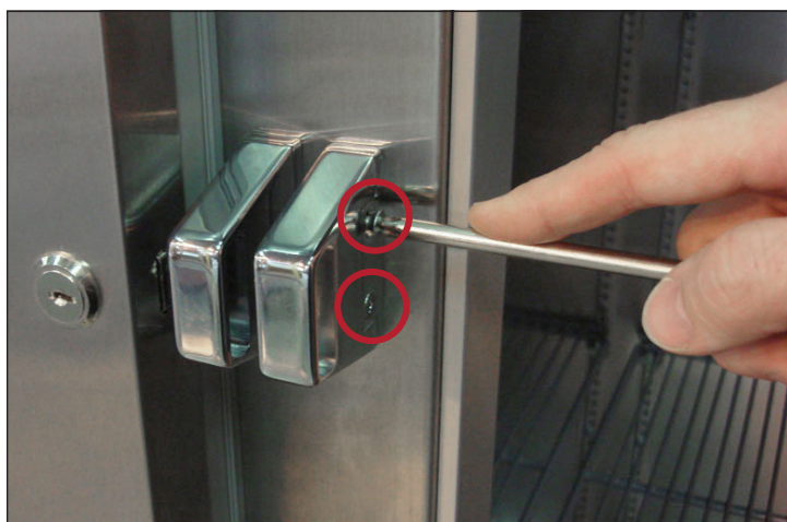
Rys. 5. Położenie wkrętów rygla zamka.
