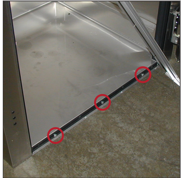
Fig. 1 Posizioni delle viti a testa zigrinata.
