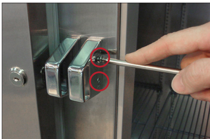
Fig. 5 Ubicazioni delle viti del chiavistello della serratura.
