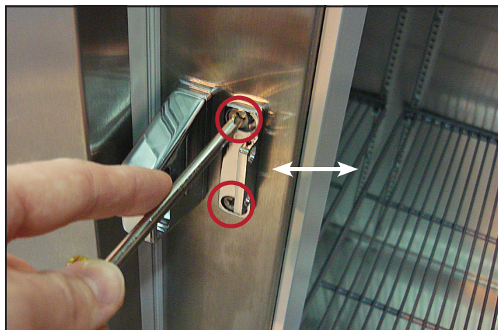
Fig. 6 Posizioni delle viti della base della serratura. Sistemare la base della serratura lateralmente.
