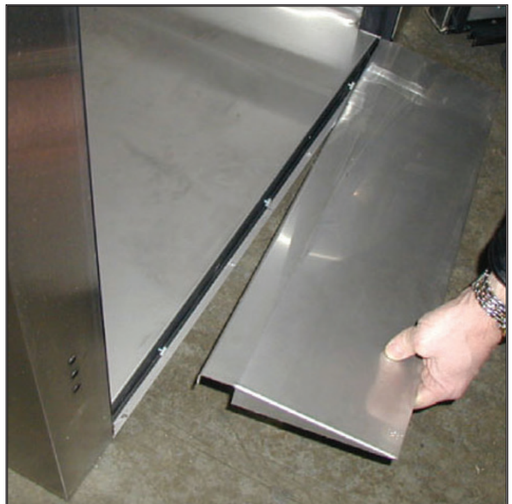
Abb. 2. Schieben Sie die Rampe auf die Flügelschrauben.
