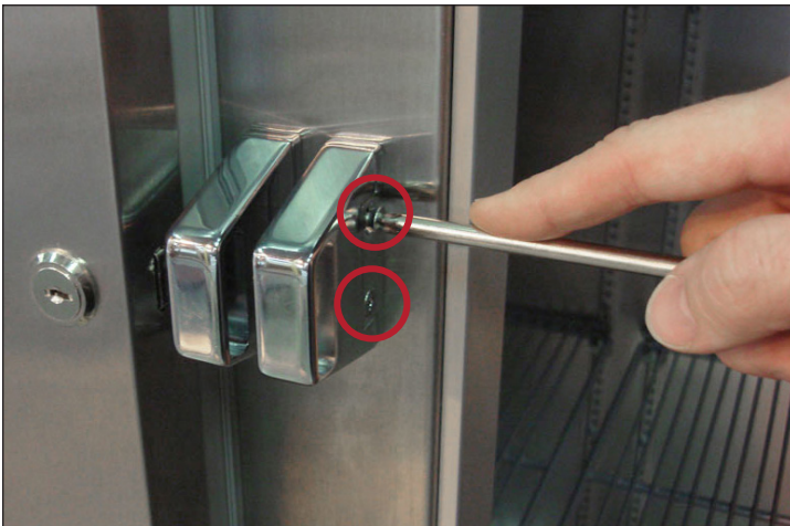
Abb. 5. Orte der Schlossriegelschrauben.
