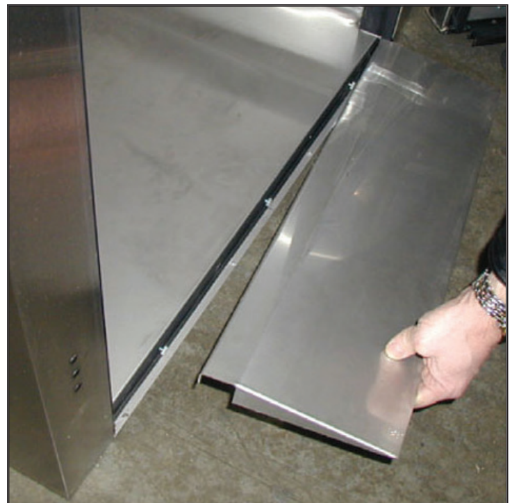
Figure 2. Glissez la rampe par-dessus les vis moletées.
