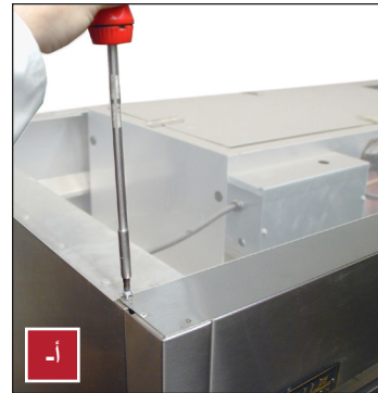
الشكل 2. إذا كان من الممكن الوصول إليها، نظف ملف المكثف. لا تستخدم الفرشاة أبدًا عبر زعانف السلك.
