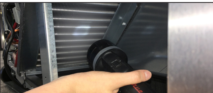
Fig. 4. Compruebe que se hayan eliminado todas las obstrucciones.
