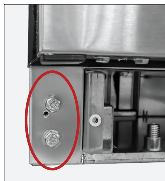
Рис. 4. Переставьте болты в первоначальное место кронштейна нижней петли.
