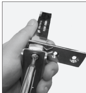
Рис. 6. Снимите кронштейн петли с пружины блока, а затем поверните его.
