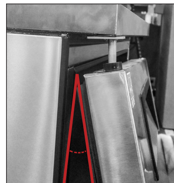
Рис. 10. При необходимости во время установки двери ее можно наклонять только под малым углом.
