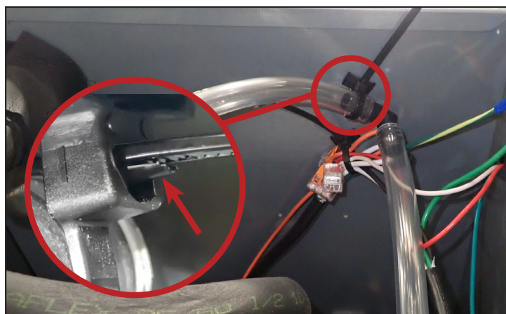
Рис. 3. Расположение фиксатора для открытия кабельной стяжки.
