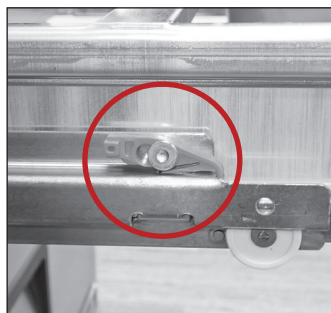
Рис. 5. Расположение фиксатора ящика. Фиксатор находится в зацеплении.
