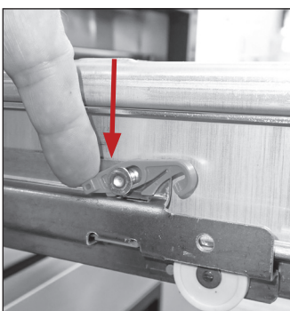
Rys. 6b. Wcisnąć w dół tył ogranicznika.
