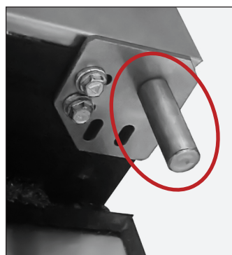
Rys. 2. Nie zatrzaskiwać tulei na zawiasie górnym.
