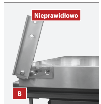
Rys. 8. Zdjęcia pokazują przód drzwi skierowany do góry.
