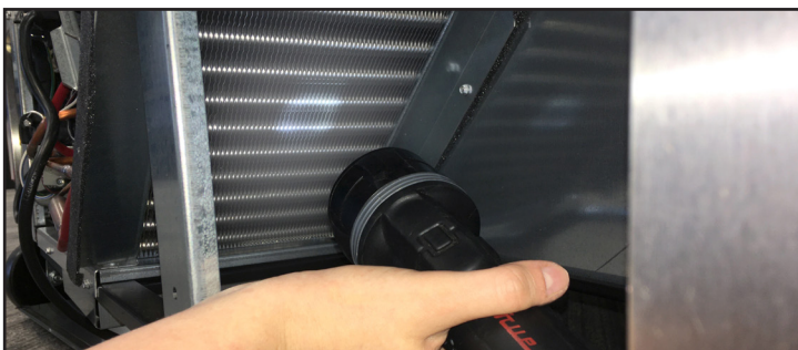
Rys. 4. Sprawdzić, czy wszystkie zatryby zostały usunięte.
