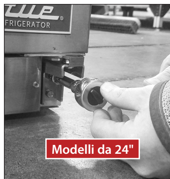
Fig. 1. I modelli da 24 e da 27 utilizzano cerniere inferiori diverse.
