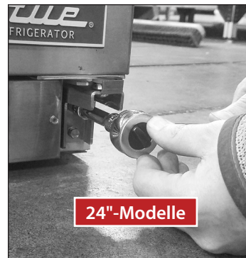
Abb. 1. An den 24"- und 27"-Modellen befinden sich unten andere Scharniere.
