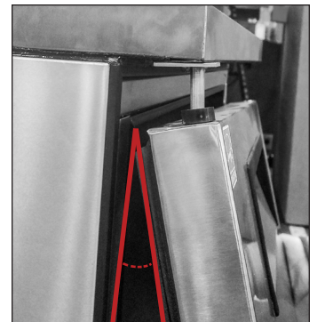
Fig. 10. Si nécessaire, utilisez uniquement des petits angles pour positionner la porte.
