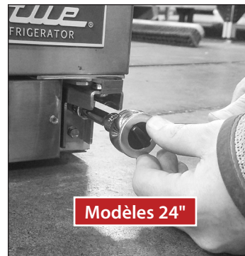
Fig. 1. Les modèles 24 et 27 utilisent différentes charnières inférieures.
