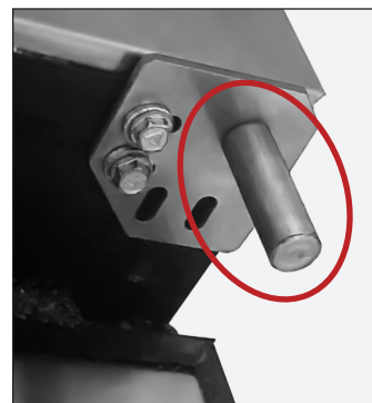
Fig. 2. Ne clipsez pas la bague sur la charnière supérieure.
