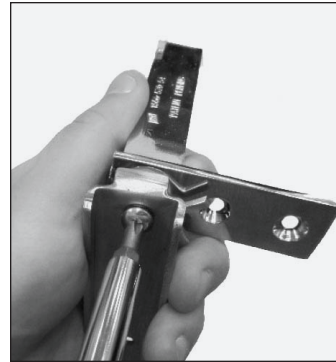
Afb. 6. Verwijder de scharnierbeugel uit het veerblok en draai deze vervolgens.
