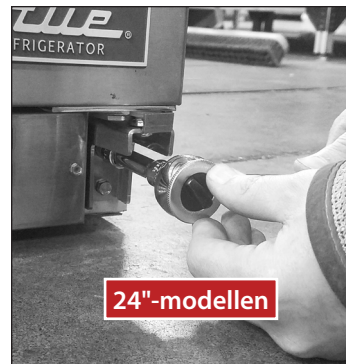
Afb. 1. De 24"- en 27"-modellen hebben andere scharnieren onderaan.
