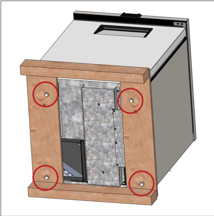
Afb. 3. Verwijder alle transportbouten.
