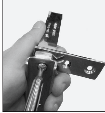
الشكل ٦. أزل كتيفة المفصلة من نابض الخرطوشة ثم أدّره.
