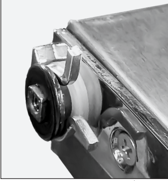
الشكل ٧. أبقِ على الحلقات المعدنية في ترتيبها الأصلي.
