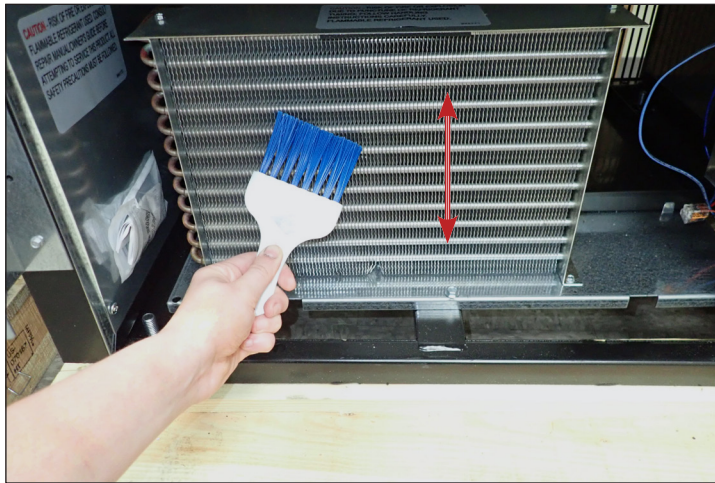
Fig. 2. Nunca pase el cepillo en perpendicular a las aletas del serpentín.
