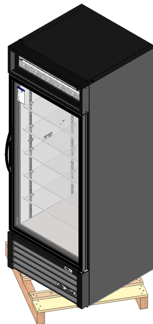
Fig. 4. Al levantar la unidad, no utilice las encimeras, puertas/cajones o rejillas como punto de elevación.
