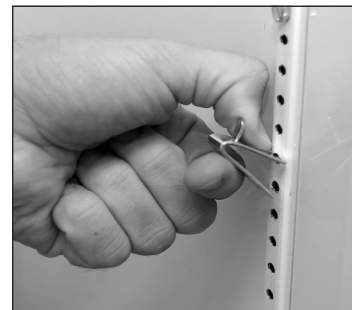
Fig. 2 La linguetta inferiore della clip si fisserà perfettamente.
