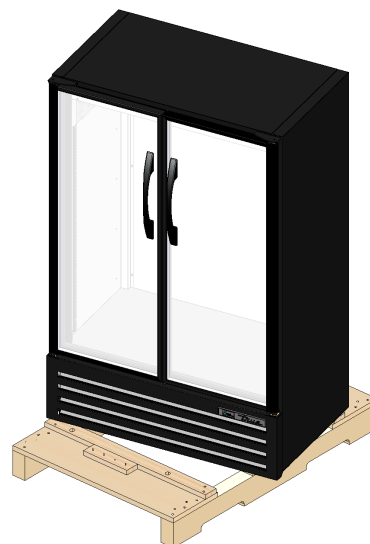
Figure 3. Pour le levage de l'appareil, ne pas utiliser les plans de travail, les portes/tiroirs ni les grilles comme point de levage.
