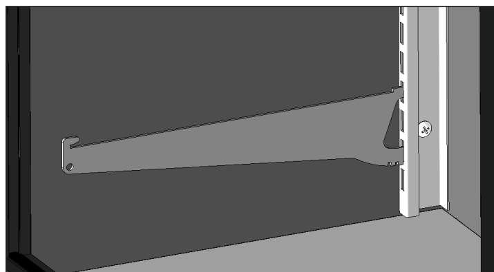
Figure 4. Console de clayette installée.
