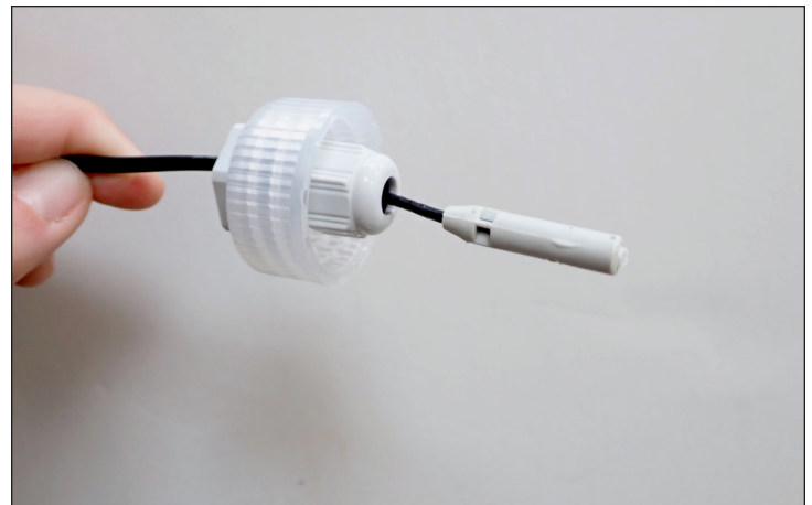
Fig. 2. Sonde de température noire traversant le capuchon avec un trou.
