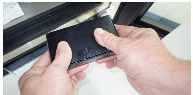
Fig. 8. Retrait du couvercle de la batterie en le faisant coulisser.
