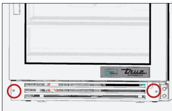
Fig. 6. Emplacements des vis de la grille de ventilation avant sous comptoir. Une fois les vis retirées, la grille reste en place grâce à un système magnétique.
