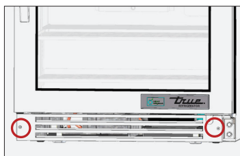
Fig. 6. Modelo bajo mostrador, ubicación de los tornillos de la rejilla frontal. La rejilla queda sujeta magnéticamente al retirar los tornillos.
