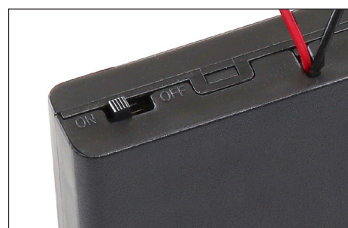
Fig. 7. Batería de reserva conmutada a ON (encendido).
