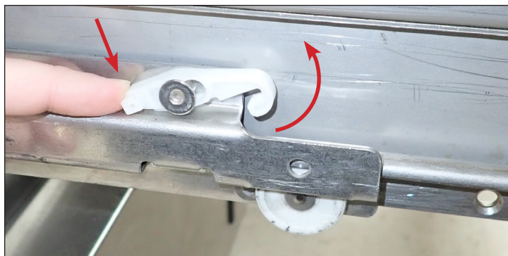
Fig. 2b. Empurrar a traseira do retentor para baixo.
