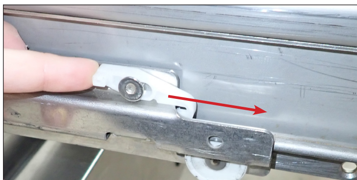
Fig. 2a. Empurrar o retentor para a frente.
