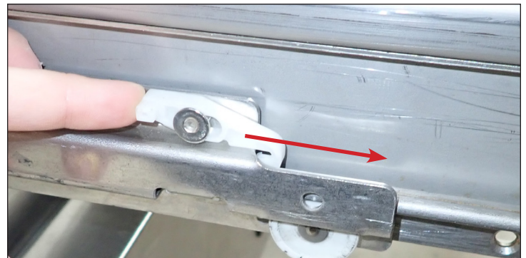
Abb. 2a Schieben Sie die Arretierung nach vorn.
