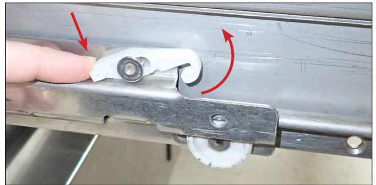
Abb. 2b Drücken Sie die Arretierung am hinteren Ende nach unten.
