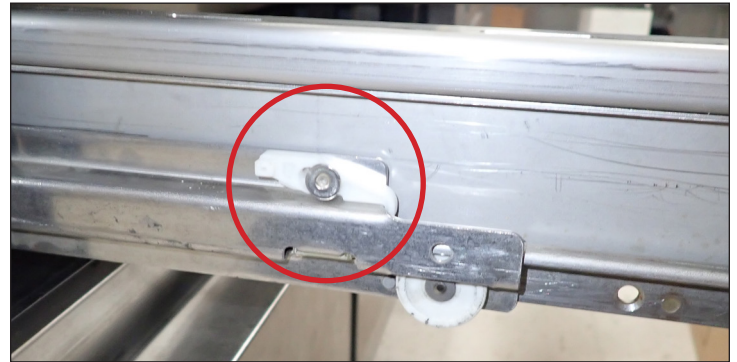
Abb. 1 Lage der Schubladenarretierung. Die Arretierung ist so aktiviert.
