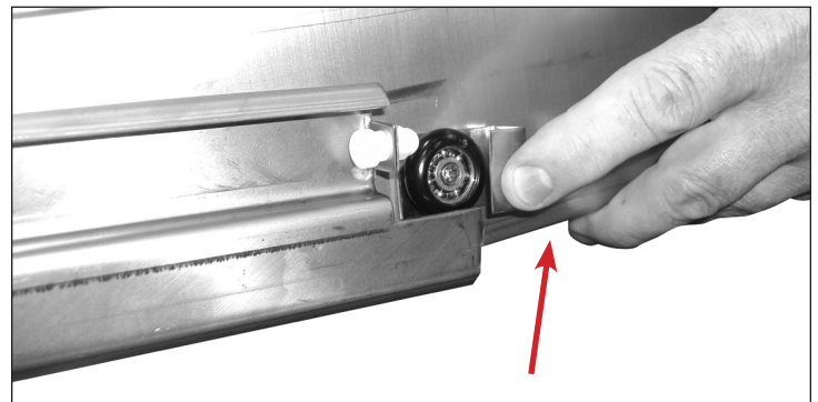
Abb. 4 Heben Sie die Schublade vorsichtig aus den Einschubschienen.
