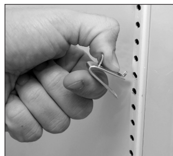
Рис. 1. Установка верхней части зажима для полки.
