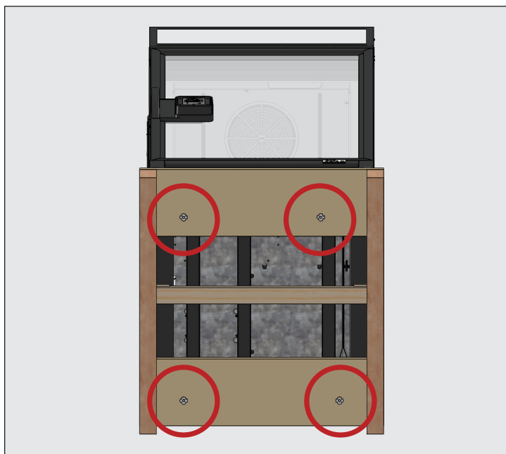
Рис. 3. Расположение транспортных болтов.
