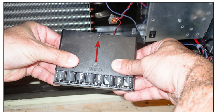
Rys. 4. Zsunąć pokrywę baterii.
