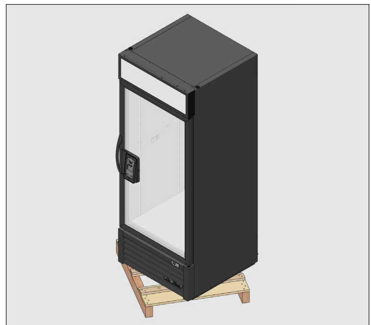
Fig. 4. Quando si solleva l'apparecchio, non usare piani di appoggio, sportelli/ cassetti o griglie come punto di sollevamento.
