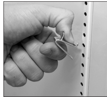
Abb. 1. Befestigung der oberen Lasche des Halters
