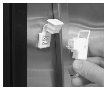
Afb. 5. Steek de lamp van het schap in.
