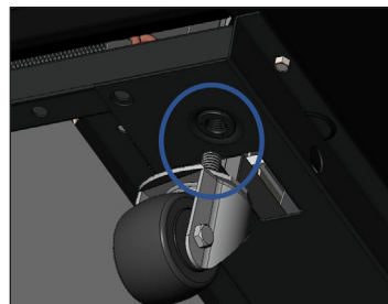
Afb. 6. Draai de bout van het zwenkwieltje los.
