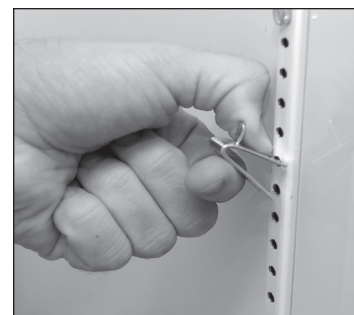
Fig. 2 La linguetta inferiore della clip si fissa perfettamente.
