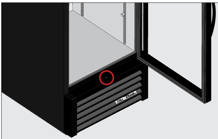
Fig. 1. Localização do parafuso da grelha no modelo com portas pivotantes.
