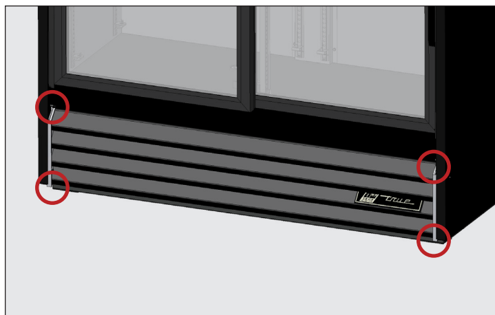
Fig. 2. Localização do parafuso da grelha no modelo com portas deslizantes.
