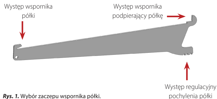
Rys. 1. Wybór zaczepu wspornika półki.
