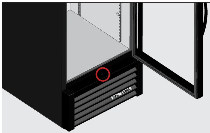
Fig. 1. Ubicazione della vite della griglia dello sportello a battente.
