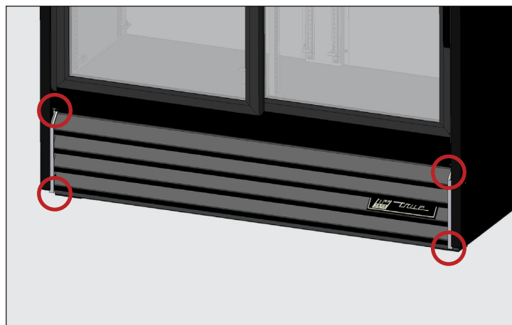
Abb. 2. Position der Schrauben am Lamellengitter der Schiebetür.
