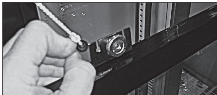
Figure 8. Glissez la languette noire qui maintient le cordon de porte pour le dégager de l'arrière de la patte de galet.
