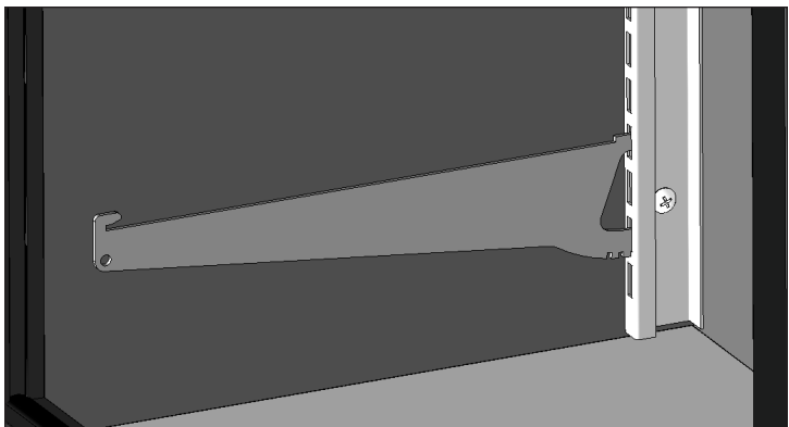
Slika 4 Ugrađeni nosač polica.
