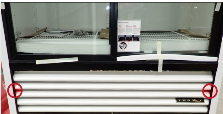
Fig. 3. Puerta corredera: Ubicación de los tornillos de la rejilla frontal.
