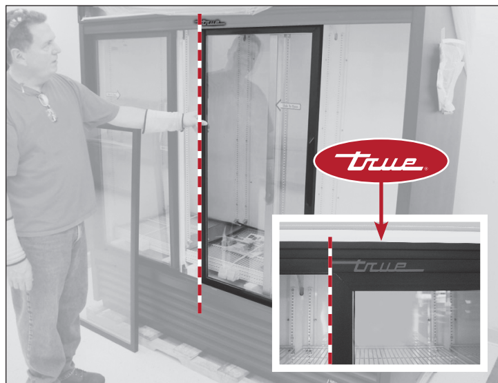
Fig. 5. Alinee el borde izquierdo de la puerta derecha con el borde izquierdo del logotipo de TRUE.
