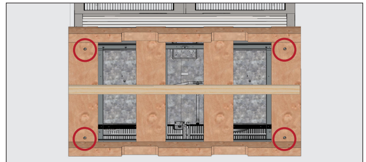
Fig. 4. Ubicaciones de los pernos de transporte.
