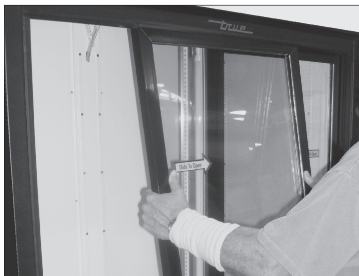
Rys. 4. Ostrożnie wyjąć drzwi.
