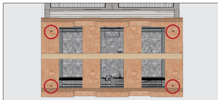
Rys. 4. Lokalizacja śrub transportowych.
