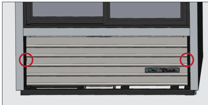
Rys. 2. Lokalizacja wkrętów kratki żaluzyjowej w urządzeniach z drzwiami przesuwными.
