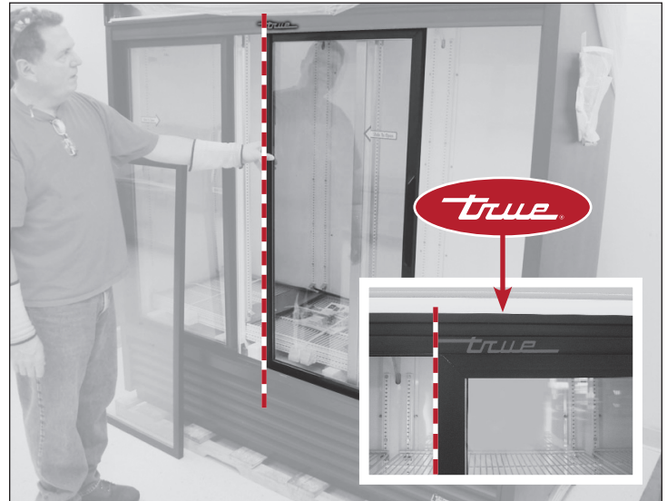
Fig. 5 Allineare il bordo sinistro dello sportello destro con il bordo sinistro del logo TRUE.
