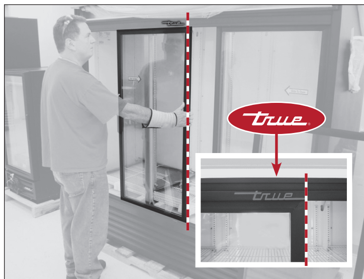
Figure 6. Alignez le bord droit de la porte gauche sur le bord droit du logo TRUE.
