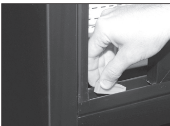
Afb. 3. Locaties van de transportblokken voor de glazen schuifdeur. Verwijder indien aanwezig en gooi niet weg.
