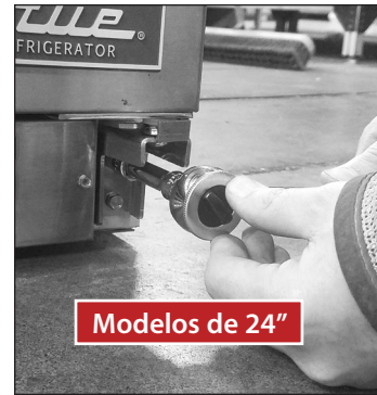
Fig. 1. Los modelos 24 y 27 usan bisagras inferiores diferentes.
