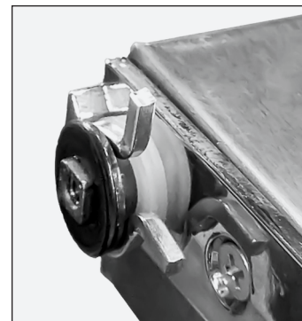
Abb. 7. Lassen Sie Beilagscheiben in ihrer ursprünglichen Reihenfolge.
