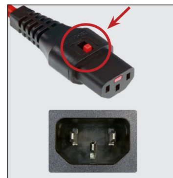
Figure 2. Poussez sur le bouton rouge pour retirer la fiche.
