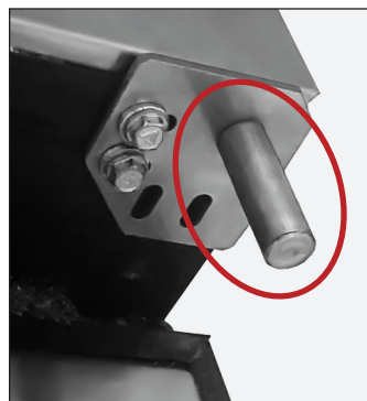
Fig. 2. Ne pas pincer la bague sur la charnière supérieure.
