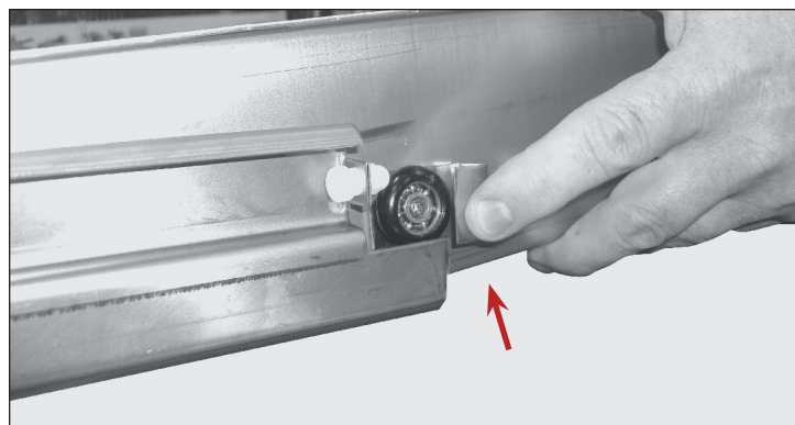
Fig. 3. Faites pivoter l'agrafe de roulette vers le haut.
