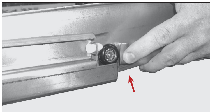
Afb. 3. Draai de clip van de roller omhoog.
