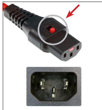
Fig. 2. Presione el botón rojo para retirar el enchufe.
