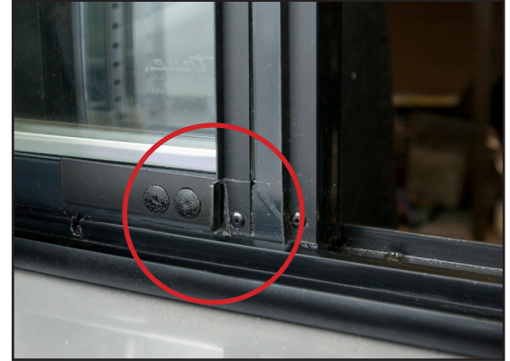
Fig. 2. El pestillo de la puerta está en posición cerrada (desenganchado de la muesca).
