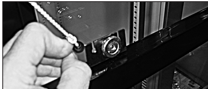
Fig. 8. Deslice la lengüeta negra que sujeta el cable de la puerta hacia la parte trasera
