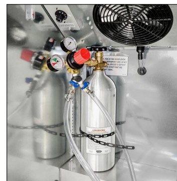
Fig. 10. Sujete siempre el cilindro de CO 2 en el gabinete.
