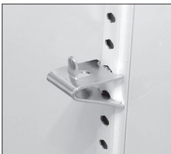
Fig. 4. Elemento de fijación del estante instalado.
