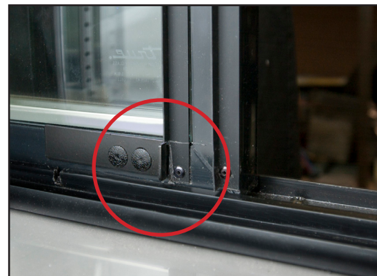
Rys. 2. Zatrask drzwi jest w pozycji zamkniętej (odłączony od wycięcia).
