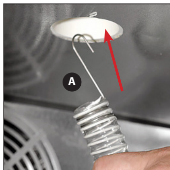
Rys. 8. Poprowadzić wąż schładzający do kolumny nalewakowej od dołu (A) i zaczepić go na górze rękawa izolacyjnego (B).
