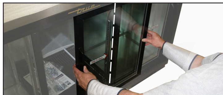
Abb. 3 Schränke mit drei Türen: Die mittlere Tür muss mittig und damit am linken Rand der rechten Tür ausgerichtet sein.
