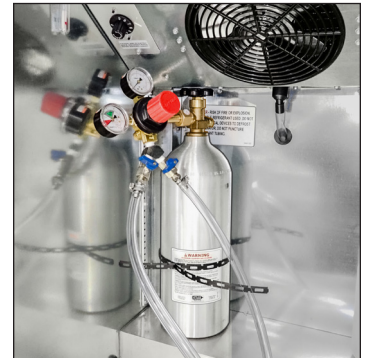
Abb. 10 Die CO 2 -Flasche stets mit der Flaschenhalterung im Kühlschrank sichern.
