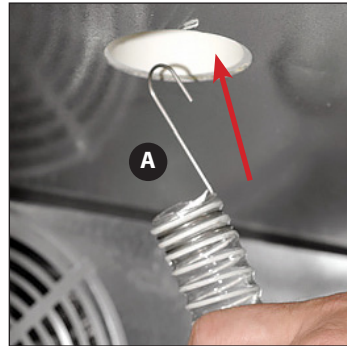
Abb. 8 Kühlschlauch von unten in die Schanksäule einführen (A) und oben an der Isolierung einhängen (B).
