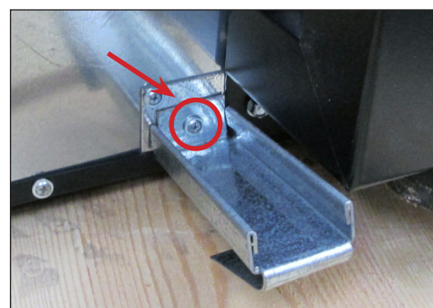
Abb. 5 Entfernen Sie alle Befestigungsbügel vom Gerät durch Lösen der Schrauben (roter Kreis). Der Pfeil zeigt auf das hintere Metallplättchen.
