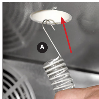
Fig. 8. Faites passer le tuyau de refroidissement dans la colonne de tirage par le bas (A) et accrochez-le au sommet du manchon d'isolation (B).
