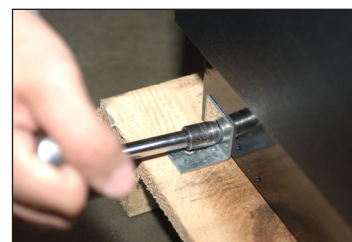
Fig. 2. Retirez le support d'expédition de la porte en verre à battant, si elle en est équipée. Ne jetez pas le support.
