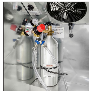
Fig. 10. Attachez toujours la bouteille de CO 2 dans l'armoire.
