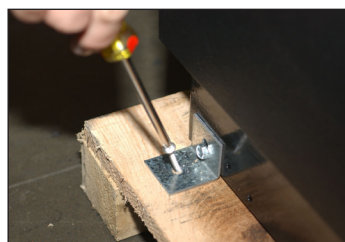
Fig. 3. S'il est présent, retirez le support en L.
