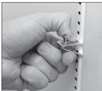
Afb. 3. Het is mogelijk dat u de onderkant van de plankdrager wat moet induwen of draaien om deze te monteren.
