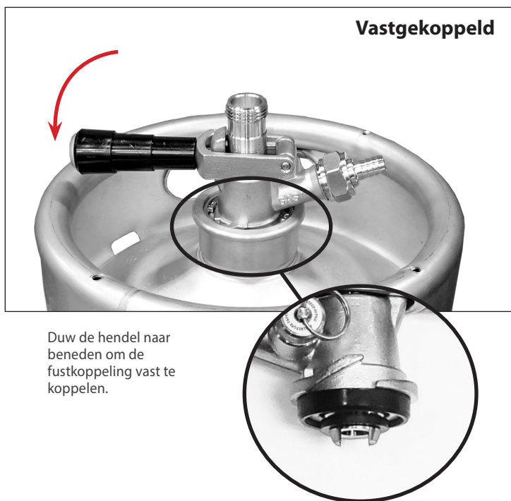
Afb. 12. Vastgekoppelde en losgekoppelde fustkoppeling
