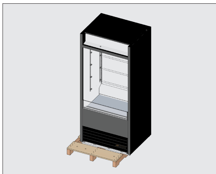
Rys. 3. Zdjąć szafę z palety i odstawić ją na bok.
