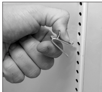
Rys. 6. Montaż górnego haczyka klipsa półki.
